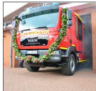
Das Allradfahrgestell mit 290 PS und einem automatisiertem Schaltgetriebe lieferte MAN als TGM 13.290. Der Aufbau stammt aus dem Hause Ziegler und wurde in Giengen an der Brenz gefertigt.
